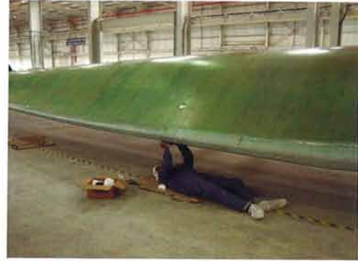
वेंगै, चेन्नई में 1 MW पवन टरबाइन के विनविण्ड पवर ऊर्जा के लिए ब्लेड उपकरणोकरण का कार्य किया गया
