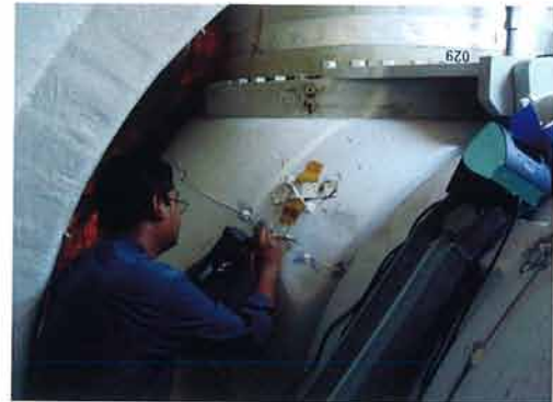
वेंगै, चेन्नई में 1 MW पवन टरबाइन के लिए विनविण्ड पवर ऊर्जा के लिए किए गए रोर उपकरणोकरण कार्य
