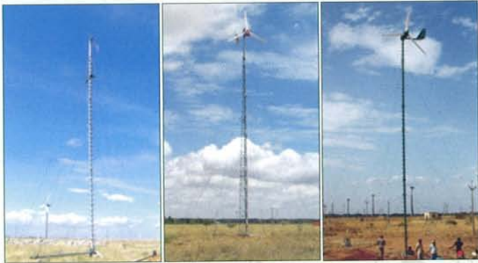
3.2 kW मॉडल 3.5 kW मॉडल 5 kW मॉडल पवन टरबाइन परीक्षण स्टेशन (डबल्यूटीआरएस), कथथार
