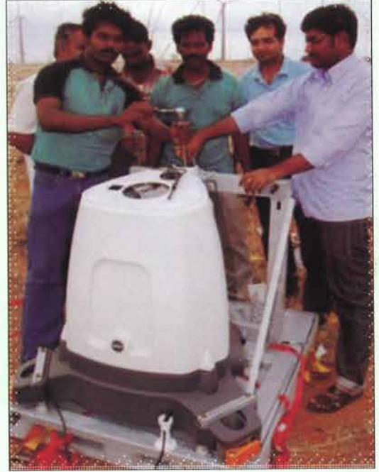
डबल्यूटीएस/डबल्यूटीआरएस, कयथार में लिडर का प्रयोगकरते हुए पवन प्रोफाइलों का मापन
