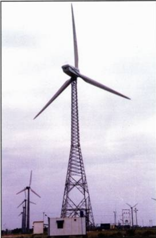
डब्ल्यूटीटीएस, कयाथार में परीक्षण के अधीन 1250 किवा. का पवन टरबाइन
