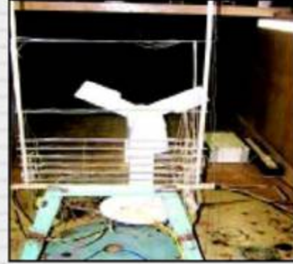
चित्र 1: एसईआरसी में पवन टरबाइन नसेल से होते हुए पवन टनेल में गति प्रोफाईल मापन
