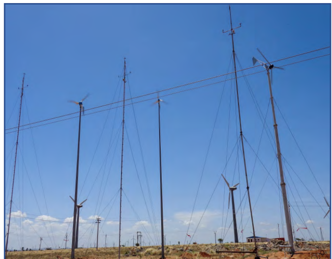
पवन ऊर्जा परीक्षण अनुसंधान स्टेशन, कायथर, में लघु पवन ऊर्जा टरबाइन का परीक्षण
