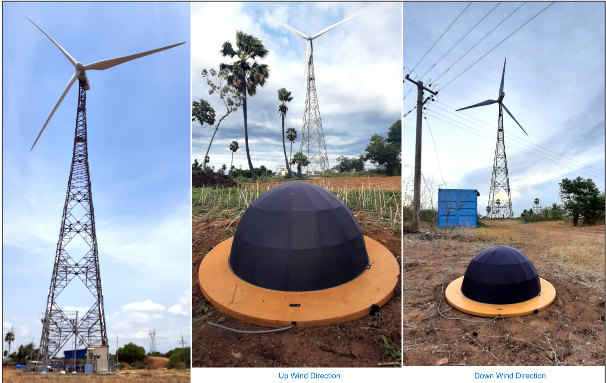
ध्वनिक शोर मापन (एएनएम) के लिए मॉडल, मेसर्स पैरा एंटरप्राइजेज प्राइवेट लिमिटेड मनूर तालुक, तिरुनेलवेली जिला, तमिलनाडु से एक पी57,750kW का पवन उर्जा टरबाइन
