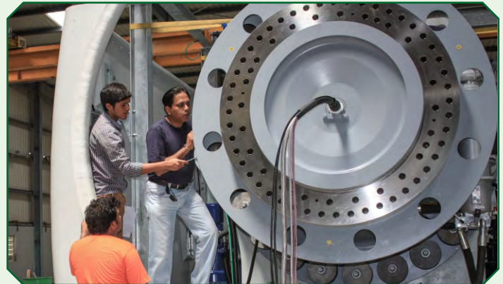
फेक्ट्री इंस्ट्रुमेंटेशन कार्य – गरुड़ 1,700.84 किलोवाट पवन टरबाइन
