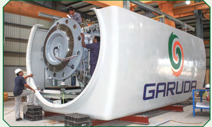
फेक्ट्री इंस्ट्रुमेंटेशन कार्य – गरुड़ 1,700.84 किलोवाट पवन टरबाइन
