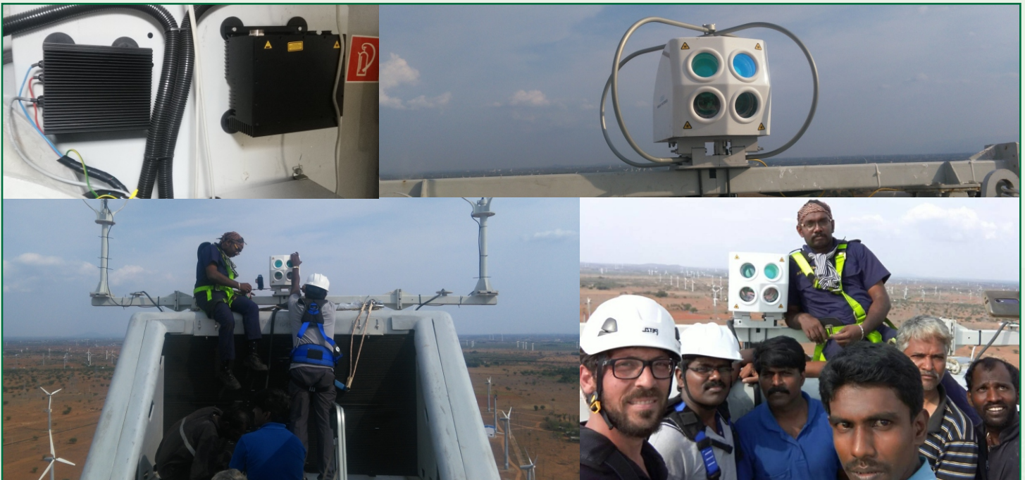
राष्ट्रीय पवन ऊर्जा संस्थान के कायथर स्थित पवन ऊर्जा टरबाइन परीक्षण स्टेशन में स्पेन की कंपनी मैसर्स विंडर फोटोनिक्स के श्री सर्जियो मार्टिनेज अलीगा द्वारा INOX-R&D में पवन ऊर्जा टरबाइन के ऊपर LiDAR आधारित संस्थापित निशे पर स्थापना और कमीशनिंग।
