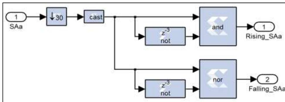
Figure 5.38 Edge detection block
